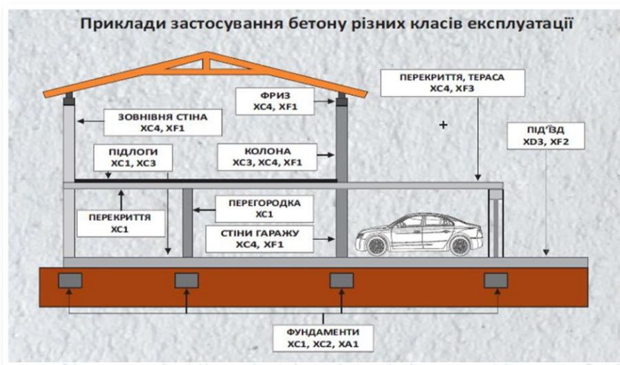
Рисунок 1 — Застосування експозиційних класів до бетонних і залізобетонних елементів однієї споруди
